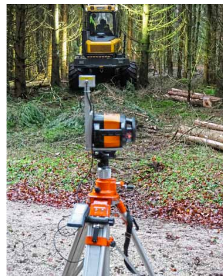
Abb. 3: Das Richtlasersystem wird an dem vormarkierten Punkt platziert. Der Maschinenführer folgt dem Laserstrahl und legt dabei die Rückegasse an.
