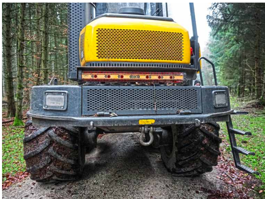
Abb. 1: Die Empfängerleiste ist etwa 1 m lang und kann mithilfe von Magneten am Harvester befestigt werden.
