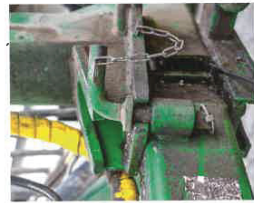
Foto: T. Meyer Während der Fahrt auf der Straße muss die Lenkdeichsel gesperrt sein
