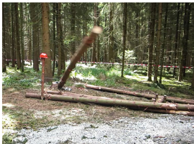
Keine Fluchtchance: Der Stamm stößt auf ein Hindernis, wirbelt durch die Luft und trifft den Windenführer (Pflock mit Helm).
