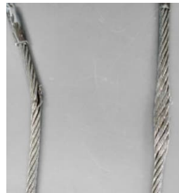
Sofort handeln: Beschädigte Seile müssen ausgetauscht werden.
